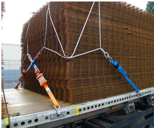
Bild 6.2: Beispiel für das Sichern eines Stapels Betonstahlmatten
