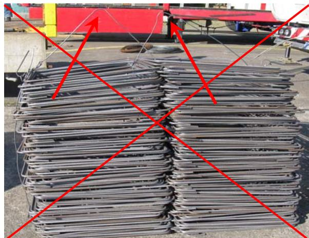
Bild 2.3: Durch Einhängen beim Umschlagen gelockerte Rödeldung; Ladeeinheit ist instabil
