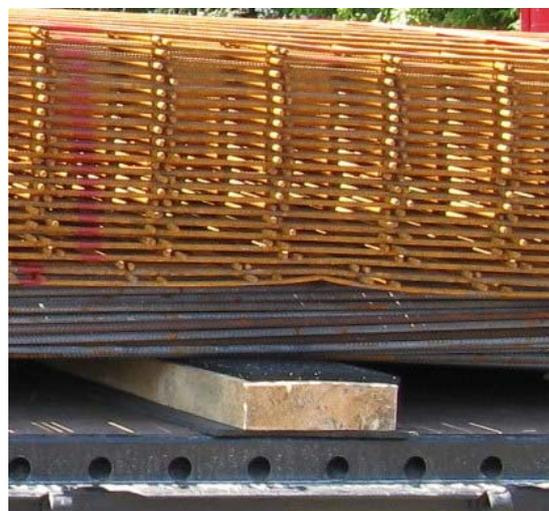
Bild 2.9: Rutschhemmendes Material auf und unter Holzunterlagen
