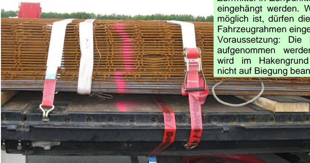
Bild 5.4: Sichern durch seitliches Umschlingen und Niederzurren
