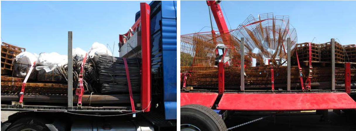
Bild 5.2: Formschluss zur Stirnwand und innerhalb der Ladung
