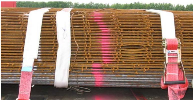
Bild 4.2: Schnittschutz und Gewebeschutzschlauch
