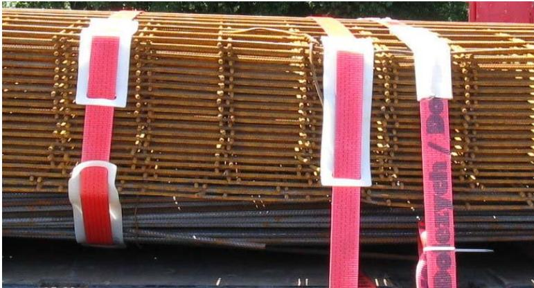
Bild 4.1: Kantengleiter und Gewebeschutzschlauch
