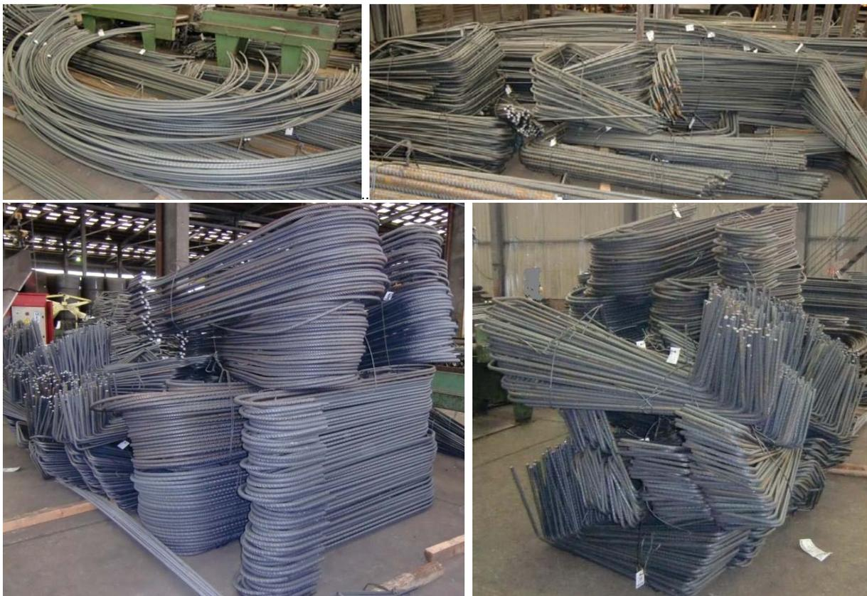
Bild 2.1: Beispiele für Ladeeinheiten Betonstahl gebogen und geschnitten
