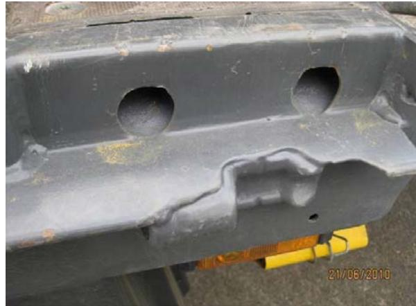
Bild 3.5: Beispiel eines Lochaußenrahmens
