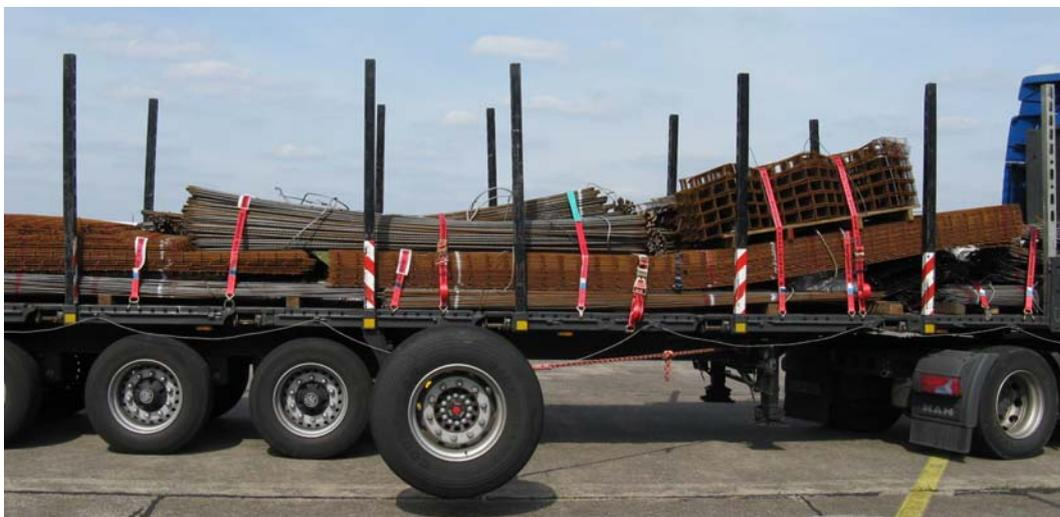
Bild 3.6: Beispiel für ein Steckrungenpaar
