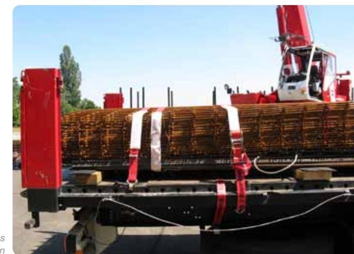
Bild 6: Sichern durch seitliches Umschlingen
