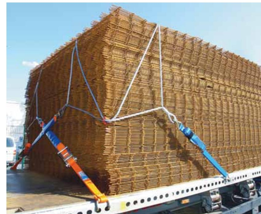
rung besteht hier darin, dass die Abbindungen, Rördelungen mit Draht oder Umreifungen mit Bandstahl, straff ausgeführt werden. Die so gebildete Ladeinheit muss auch nach mehrmaligem Umschlagen stabil bleiben, die Abbindungen müssen gegebenenfalls nachgespannt werden.
