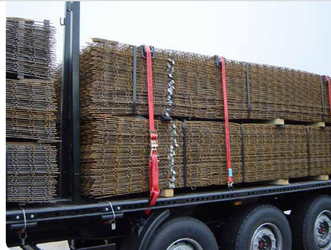
Bild 4: Sichern paketierter Mattenstapel durch Rungen und Niederzurren
