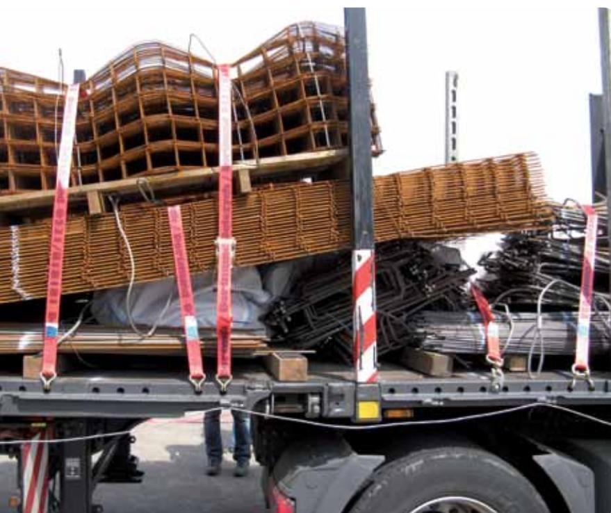
Bild 5: Sichern durch Rungen und Niederzurren
