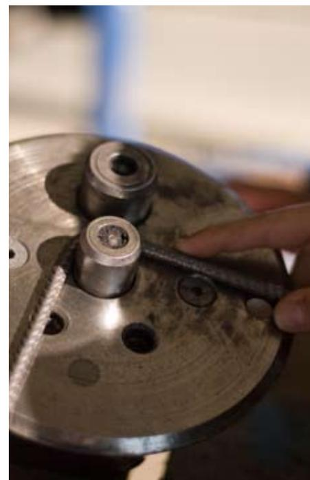
Überprüfung des Biegerolldurchmessers
