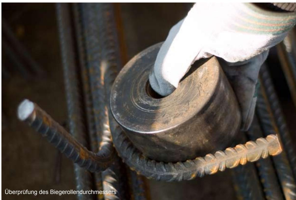
Überprüfung des Biegerolldurchmessers
