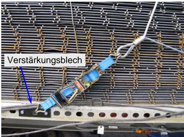
Bild 4: DoZurr 8000-kraftverstärkt angelegt
