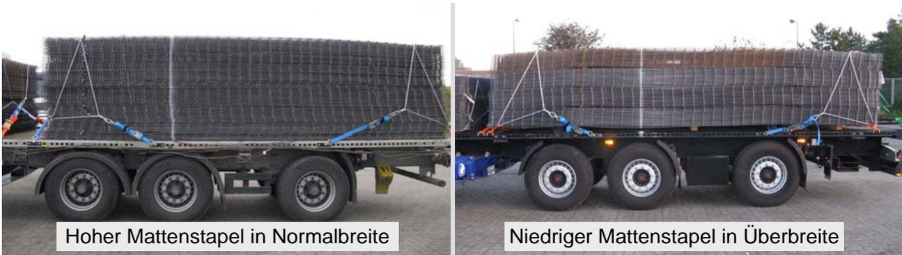
Bild 1: Stapel Betonstahlmatten mit DoUniFlex-Betonstahlmattensicherung gesichert
