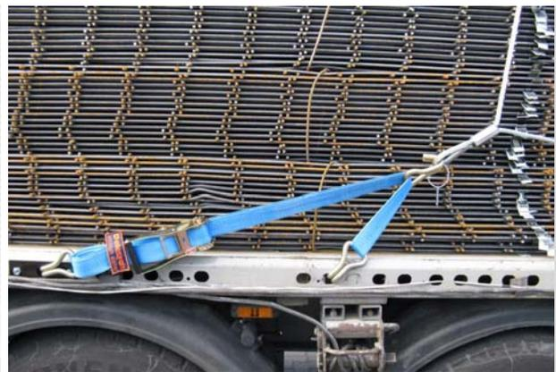
Bild 5: DoZurr 8000-kraftverstärkt in zwei Zurrpunkte eingehängt
