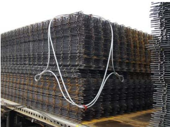
Bild 2: DoUniFlex-Seilschlinge angelegt
