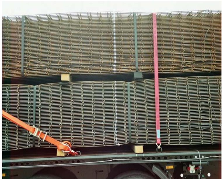
Laden und Sichern von paketierte Betonstahlmatten auf Straßenfahrzeugen
