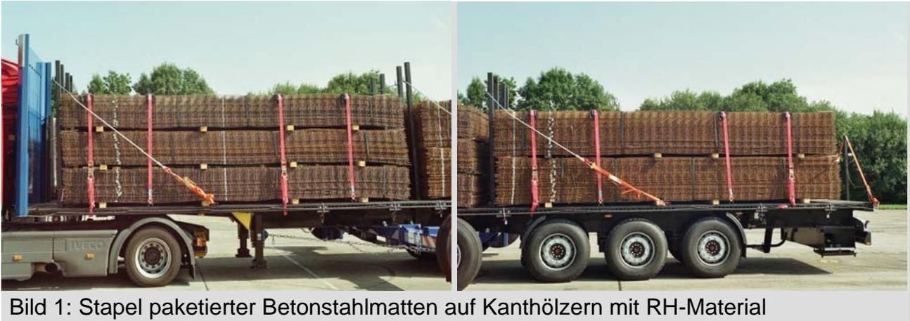
Bild 1: Stapel paketieter Betonstahlmatten auf Kanthölzern mit RH-Material
