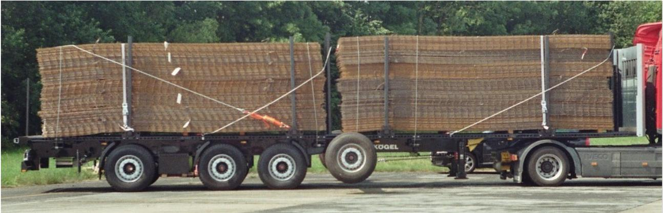
Bild 1: Ladung Betonstahlmatten gesichert mit KÖGEL - STEELFIX-Ladungssicherungssystem
